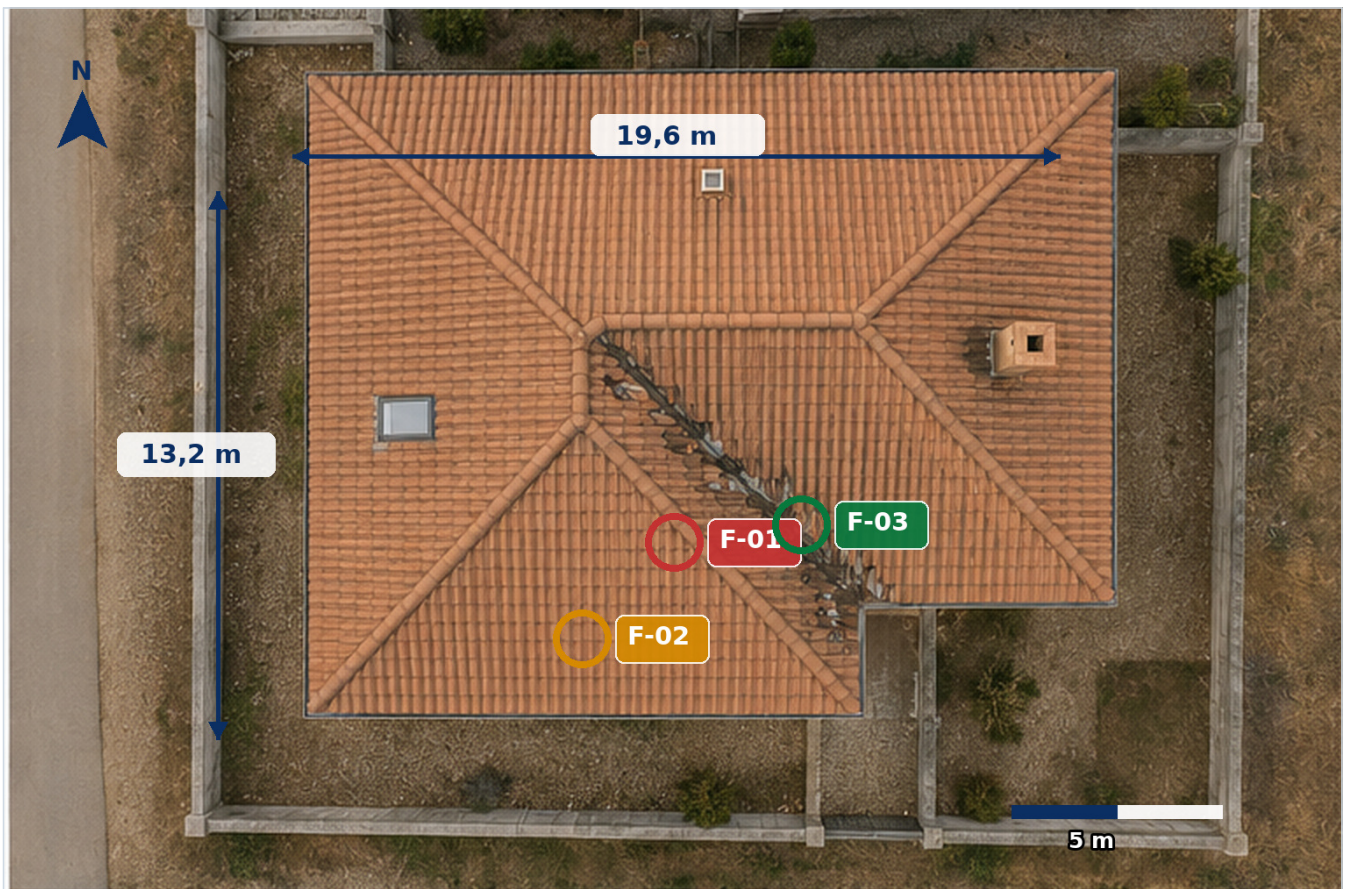
Figura 3. Vista nadir utilizada como base del plano de daños. Dimensiones, escala, orientación y superficies son valores simulados para mostrar el formato de entrega.
